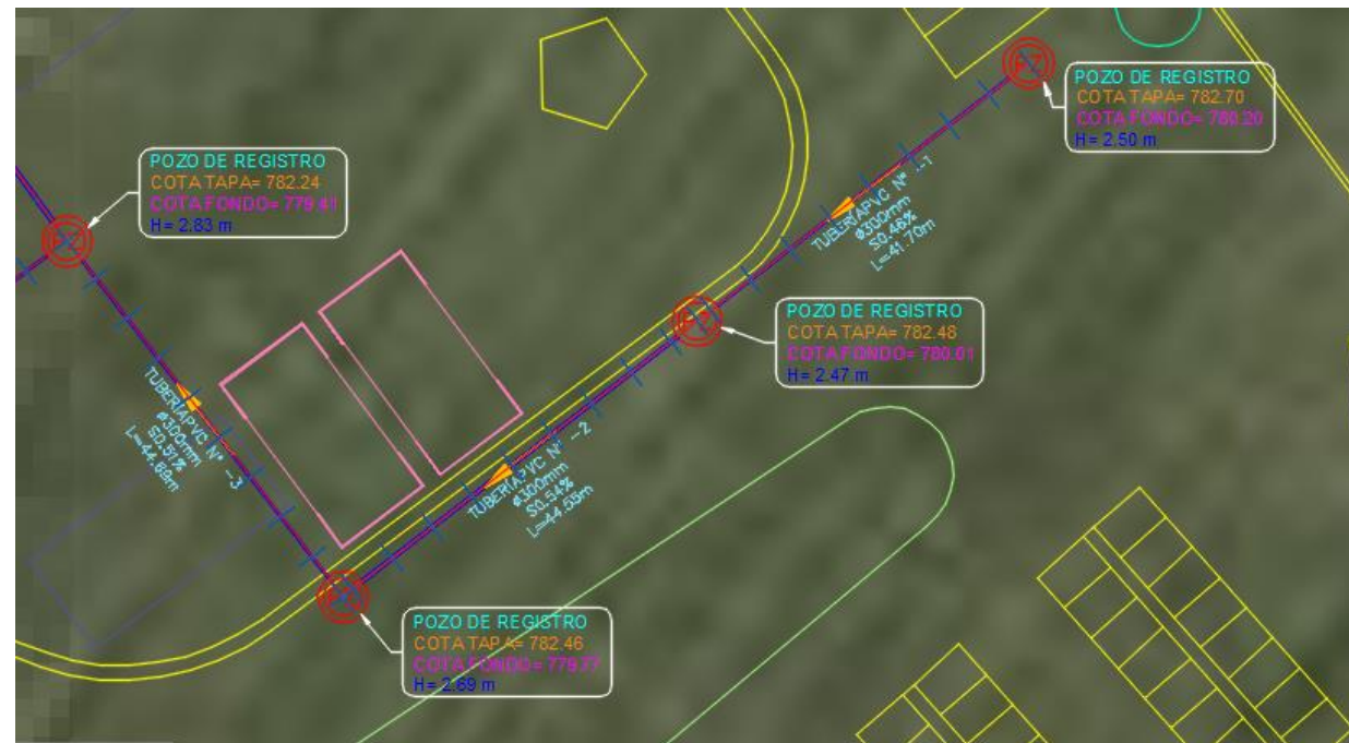
Ilustración 9: Detalle tuberías y pozos de registro de la red de fecales.
