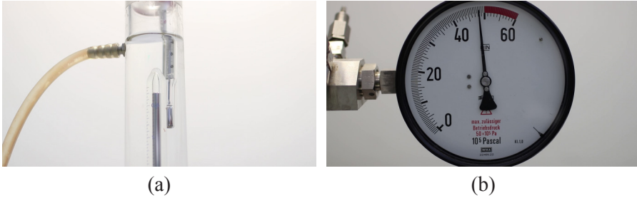
Figura 20. Intento de reducción de volumen del líquido: (a) El volumen casi no varía; (b) La presión aumenta bruscamente.
