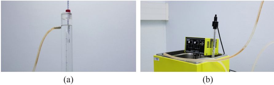
Figure 5. (a) Tube concentrique rempli d'eau autour du tube de mesure; (b) Bain thermostatique du contrôle.
