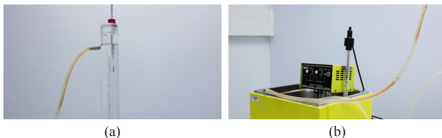
Figura 5. (a) Baño concéntrico de agua sobre el tubo de medida; (b) Baño termostático de control.
