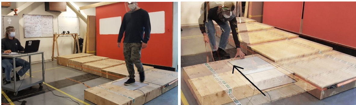
Fig. 2 – Piloto para la experimentación en el LDH: pasajero pisando la placa de fuerza (izquierda), movimiento de cajón “andén” para diferentes BR (derecha)
