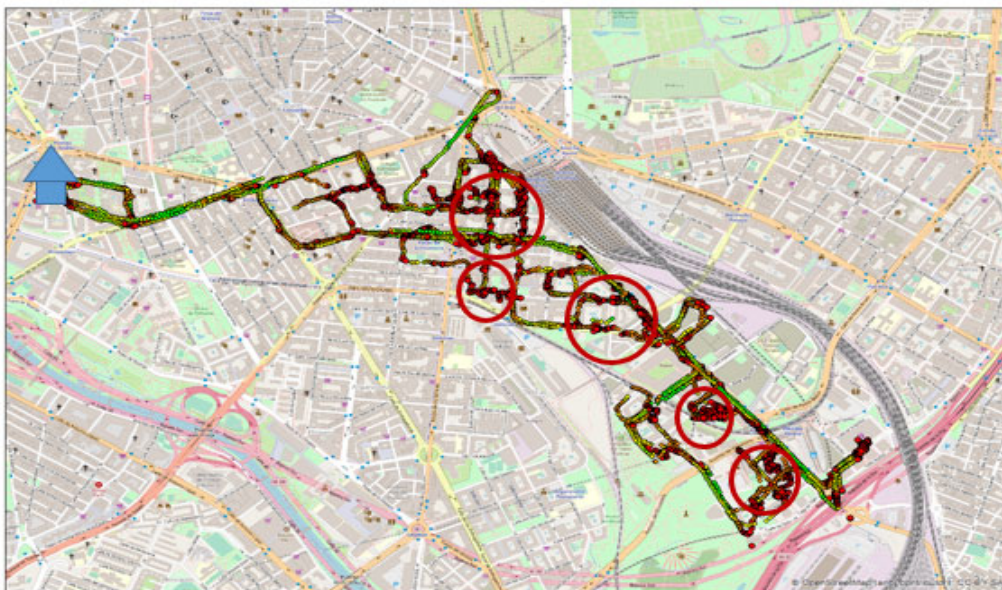
Figura 3-Posicionamiento y velocidad instantánea de un vehículo durante una ruta de reparto en el centro ciudad (Boggio-Marzet y Monzón, 2021)
