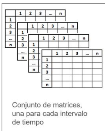
Fig. 2: Ilustración de consideración de la dinámica de la demanda mediante series de matrices OD por intervalos de tiempo
