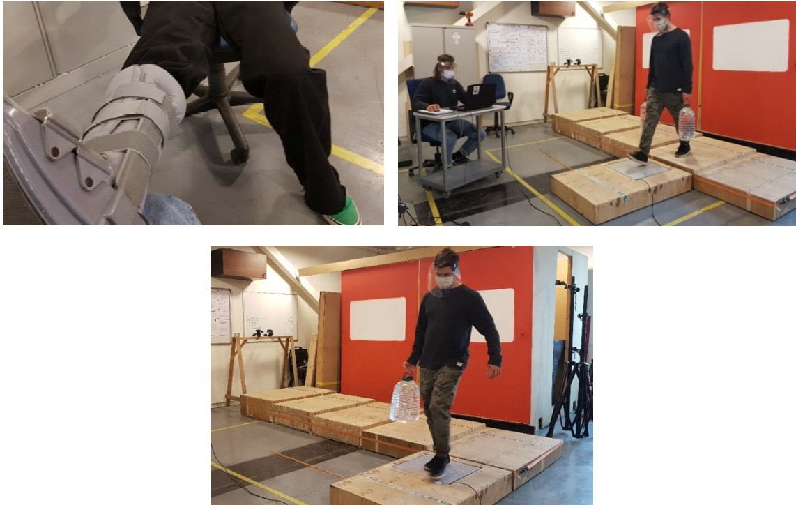
Fig. 3 – Casos a considerar en los experimentos de laboratorio: bota ortopédica (superior izquierda), carga simétrica (superior derecha), carga asimétrica (inferior).
