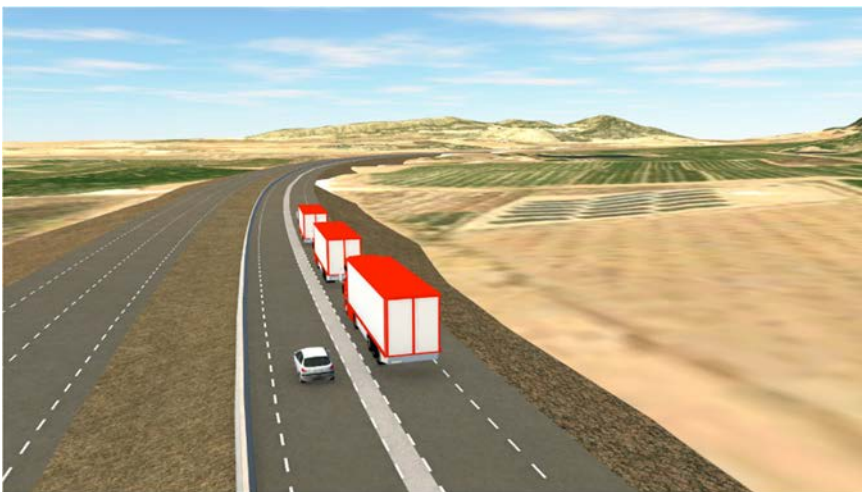
Figura 3: Simulación de un vehículo adelantando a un 'platoon' de camiones, tras la actuación propuesta
