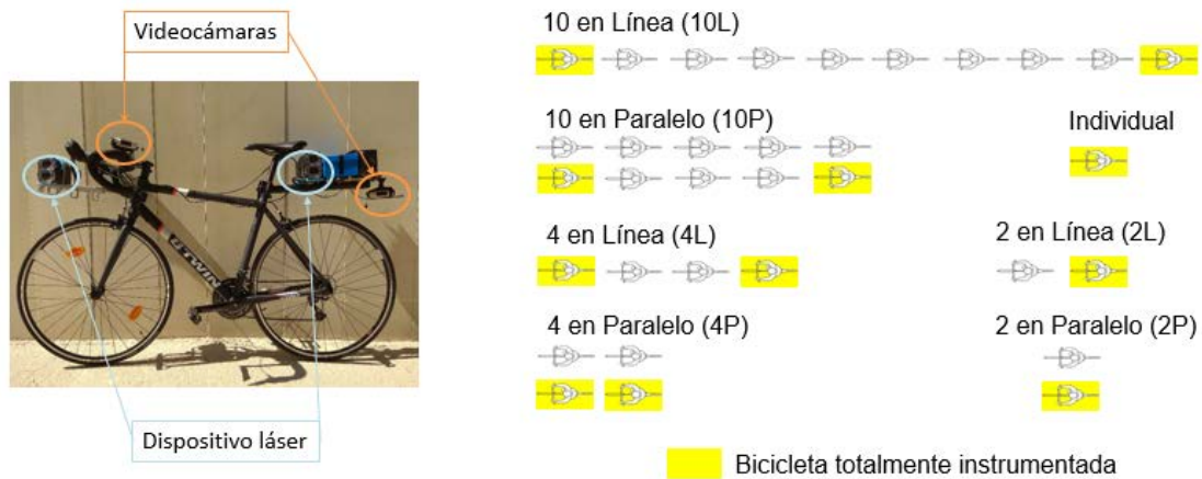
Fig. 2 - Bicicleta instrumentada y configuraciones estudiadas.
