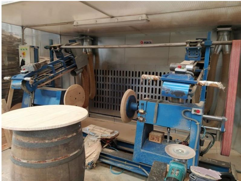
Figura 1. Lijadora automática empleada en la transformación primaria de la madera.
