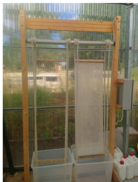
Imagen 1. a) Planteamiento de las tareas y etapas de la investigación. b) Prototipo de reactor de algas soportadas.
