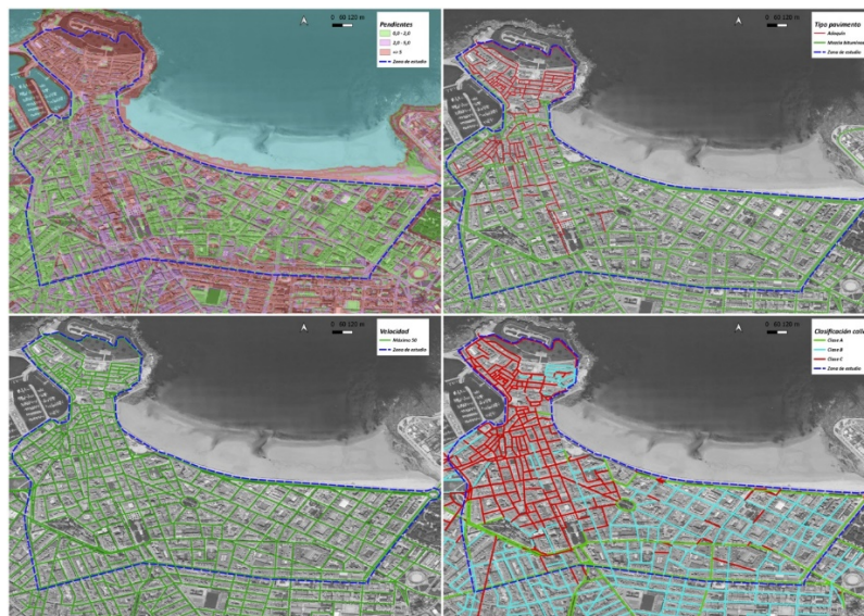
Figura 4 – Datos de pendientes, tipo de pavimento, velocidad máxima permitida y tipos de calles (A, B o C, en función del árbol de decisión citado).
