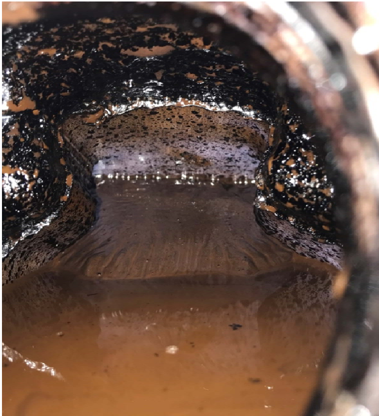
Fig. 4 – Sedimentos dejados por la emulsión eNanocel-07.
