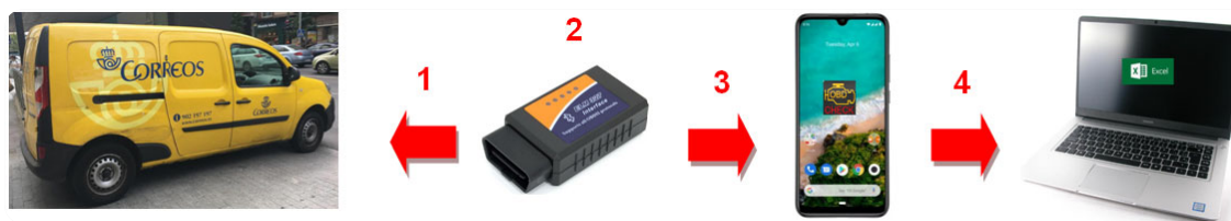
Figura 2. Esquematación del proceso del sistema de obtención y almacenamiento de datos.
