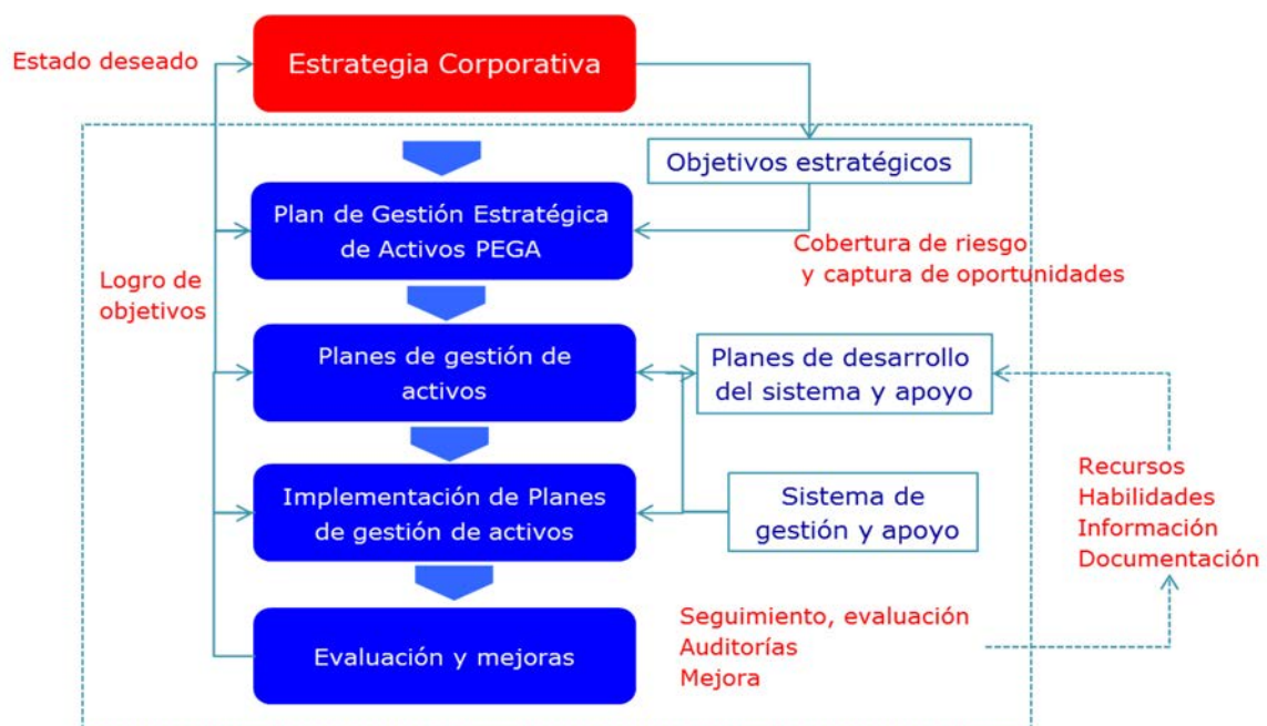
Fig. 1 - Relación entre los elementos clave de un sistema de gestión de activos. Fuente: Elaborado a partir de Anexos B de ISO 55000.
