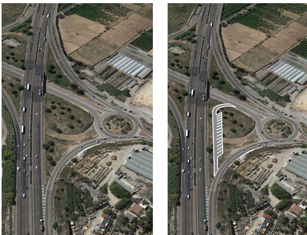
Figura 12: Zona de detención segura en un nuevo ramal de uso específico. Fuente: Adaptada de Google.
