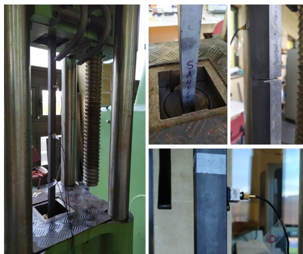
Figura 2. Setup experimental para el ensayo de fatiga con acelerómetros.
