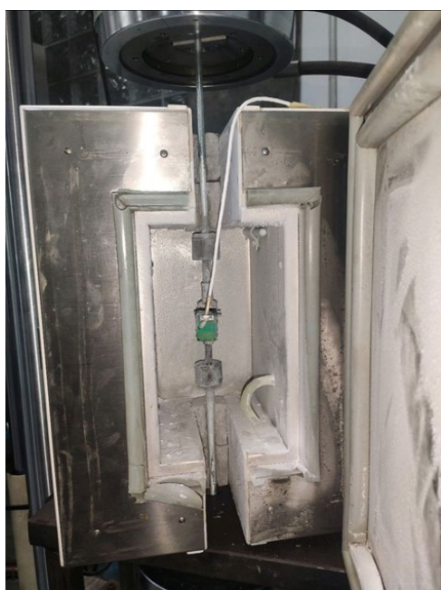
Figura 4. Montaje para ensayos de fractura con MCT utilizado en las instalaciones de la UC
