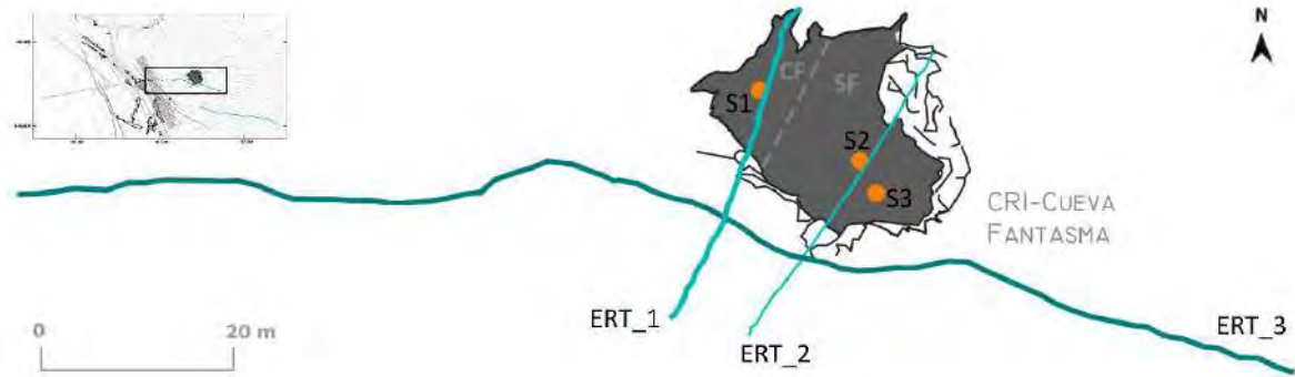
Figura 4.12. Mapa de detalle de la localización de los perfiles de ERT y los sondeos mecánicos realizados en torno a Cueva Fantasma.
