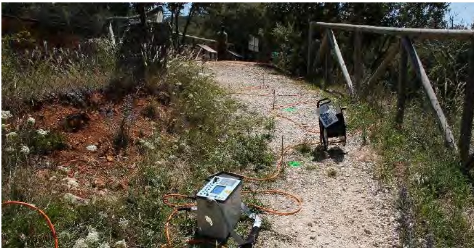
Figura 4.26. Perfil ERT_5 a su paso por el yacimiento de Penal, durante su realización en 2015. A mano izquierda se pueden observar los sedimentos terrígenos que rellenan la cueva.
