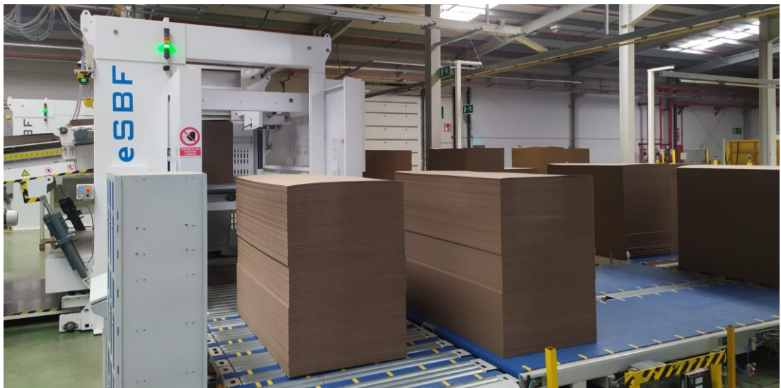
Figura 1. Rodillos de entrada. Fuente (Elaboración propia)
