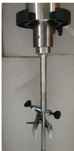
**Figura 6.** Homogeneizador ultrasónico Vibra-cell VCX 500.
