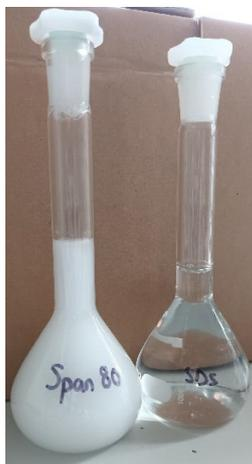
**Figura 5.** Disoluciones de Span 80 (izquierda) y de SDS (derecha).
