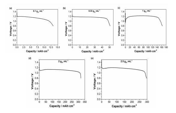
Figure 6 - 6. Voltage profiles of 100 % discharged batteries with different Zn content. (a) 0.1  $kg_{Zn}L^{-1}(b)$  0.33  $kg_Z L^{-1}(c)$  1  $kg_{Zn}L^{-1}(d)$  2  $kg_{Zn}L^{-1}(e)$  2.5  $kg_{Zn}L^{-1}$ .
