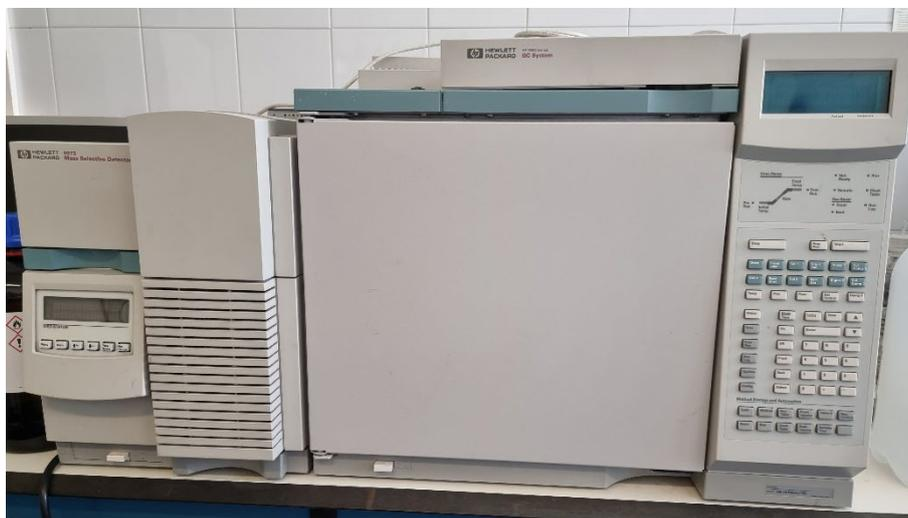
**Figura 19. Cromatógrafo de gases HP 6890 Hewlett Packard con inyector Split/Splitless**
