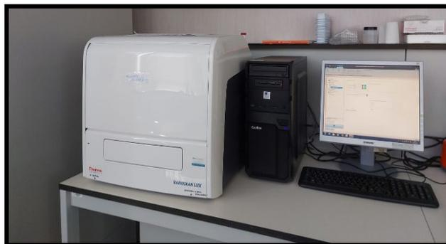
**Figura 37. Fluorímetro Lector de microplacas Varioskan LUX**
