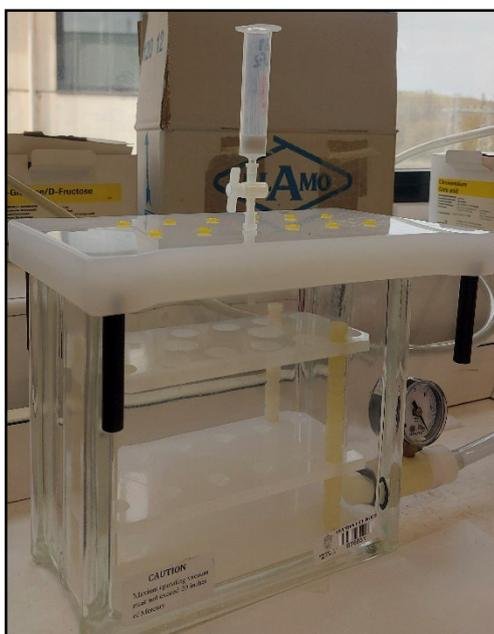
**Figura 32. Cartuchos Strata-X SPE y sistema Manifold para extracción**
