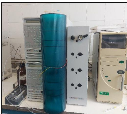
*Figura 33. Cromatógrafo de líquidos Varian Pro Star 310 con detector UV*
