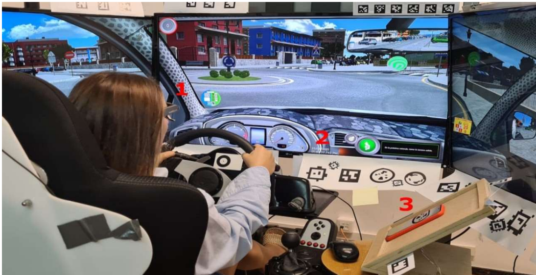
Ilustración 2 – Simulador con smartphone y eye tracker.
