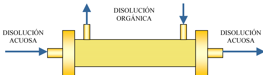
Figura 4.3. Configuración de un módulo de membrana de función única para extracción líquido-líquido.
