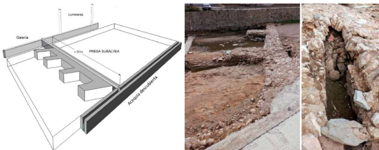
Figura 2. Presa subálvea superior: reconstrucción 3D, vista general y vista en detalle de la galería.
