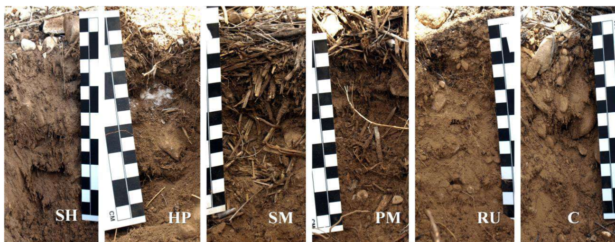
Figura 2. Perfiles de suelo para los seis tratamientos aplicados. Donde: SH, estiércol; HP, polímeros hidroabsorbentes; PM, mulch de poda; SM, mulch de paja RU, lodo de depuradora; C, control. En la regla cada cuadrado pequeño representa 1 cm. Fuente: Elaboración propia.
