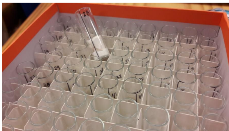
Figura 3.5. Viales de silicato de boro de 10 mm de diámetro, con la muestra en su interior y la marca de orientación grabada en el vial.
