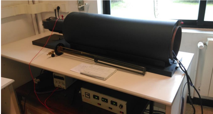
Figura 3.16. Horno TD48 – SC (ASC) de una sola cámara con bobina para generar un campo magnético axial. Laboratorio de Paleomagnetismo de la Universidad de Burgos.
