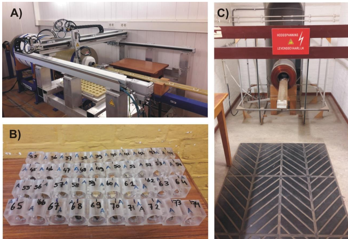
Figura 3.18. Ilustración del método de Pseudo-Thellier empleado en el laboratorio de paleomagnetismo Fort Hoofdijk de la Universidad de Utrecht (Holanda). Método Pseudo-Thellier: A) Sistema robotizado del magnetómetro 2G DC-SQUID de Utrecht. B) Muestras preparadas dentro de los portamuestras correspondientes para introducirlas en el sistema robotizado. C) Bobina AF construida en ese laboratorio para aplicar pasos de hasta 300 mT.
