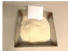
Triturado y tamizado (pasa del tamiz de 2,00 mm)
