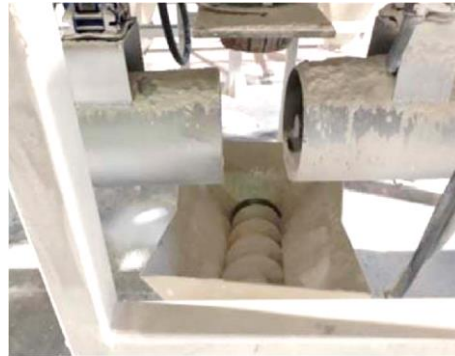
Figura 8.8. Tornillo sin-fin de dosificación perdida de materias primas (escayola y poliuretano triturado)
