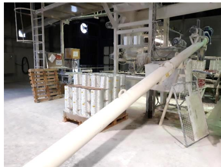
Figura 8.9. Tornillo sin-fin mezclador de materias primas (escayola y poliuretano triturado)
