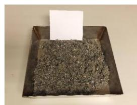
Triturado y tamizado (pasa del tamiz de 4,00 mm)
