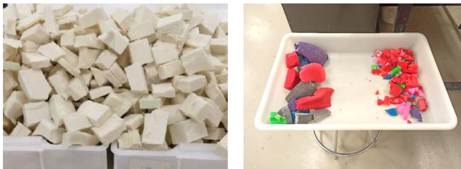
Figura 6.10. Residuos tipo B y ES reducidos a piezas de menor tamaño antes de su trituración
