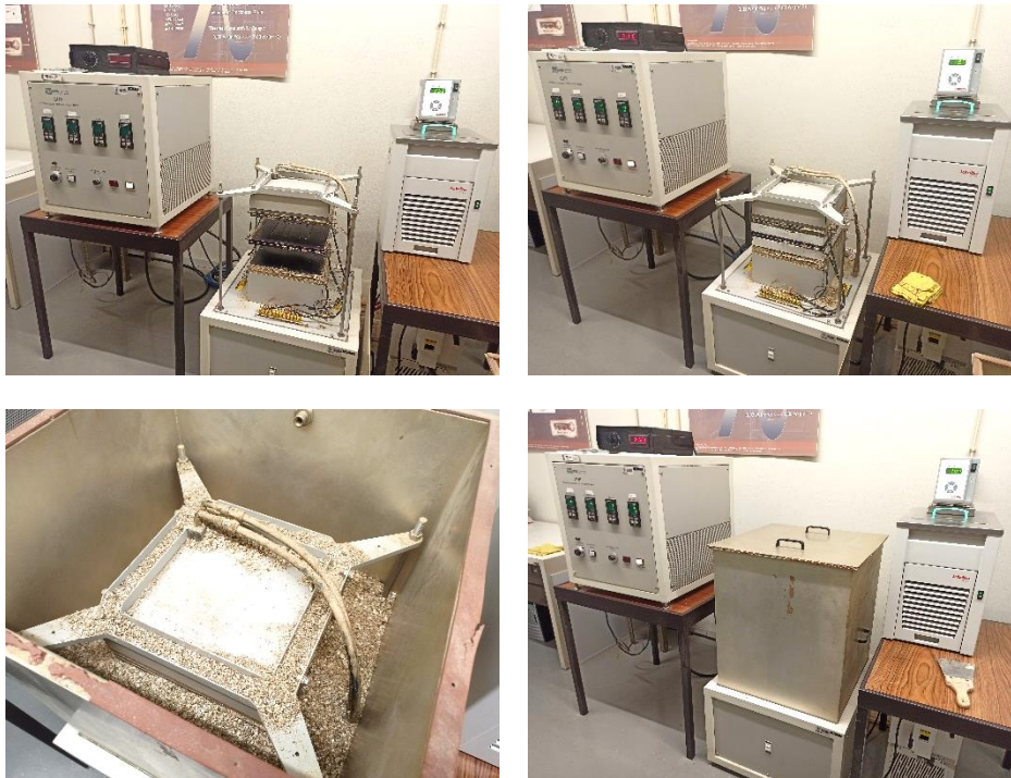
Figura 5.9. Equipo y procedimiento de ensayo de placa caliente guardada (FEUP)
