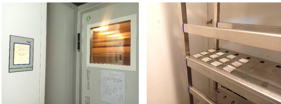
Figura 5.28. Cámara climática tipo Fitoclima 3600 EDTU y muestras de ensayo en su interior
