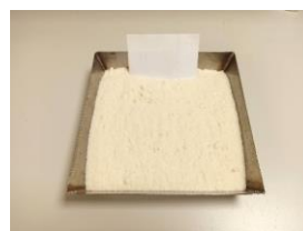
Triturado y tamizado (pasa del tamiz de 2,00 mm)
