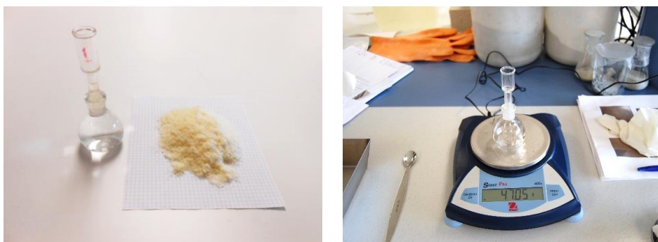
Figura 5.4. Procedimiento para determinar la densidad real a través del método del picnómetro
