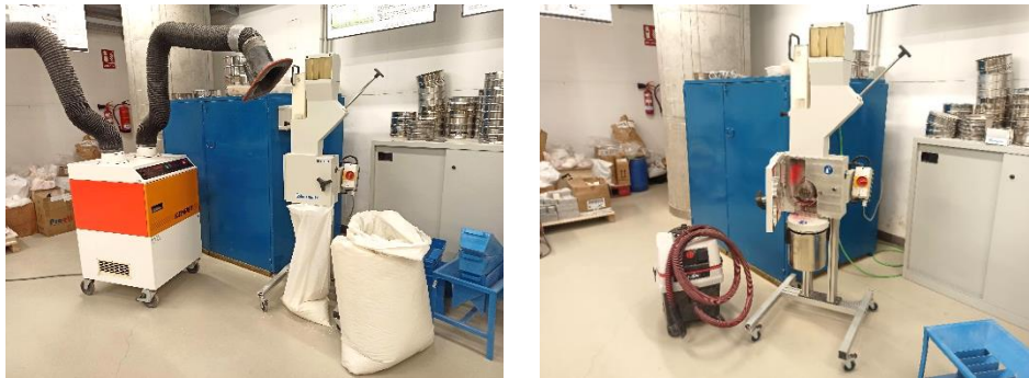
Figura 6.11. Equipo RETSCH SM100 empleado en la trituración del residuo de poliuretano
