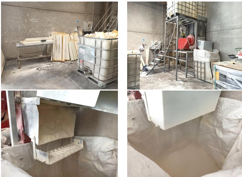
Figura 8.2. Proceso de corte y trituración y poliuretano en polvo
