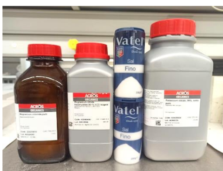
Figura 5.31. Sustancias empleadas para las soluciones saturadas en el método de desecador
