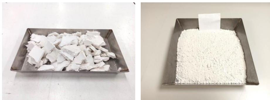
Figura 11.1. Residuo de placa de yeso tras el proceso de fragmentación manual (izquierda) y de trituración (derecha)
