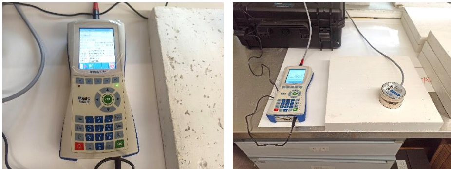
Figura 5.7. Equipo y procedimiento de ensayo con ISOMET 2114
