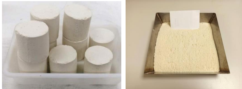
Figura 6.4. Residuo de poliuretano tipo P según el formato suministrado (izquierda) y tras el proceso de trituración (derecha)
