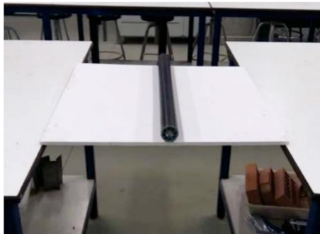
Figura 5.14. Procedimiento de ensayo para determinar la resistencia a flexión según UNE-EN 14246
