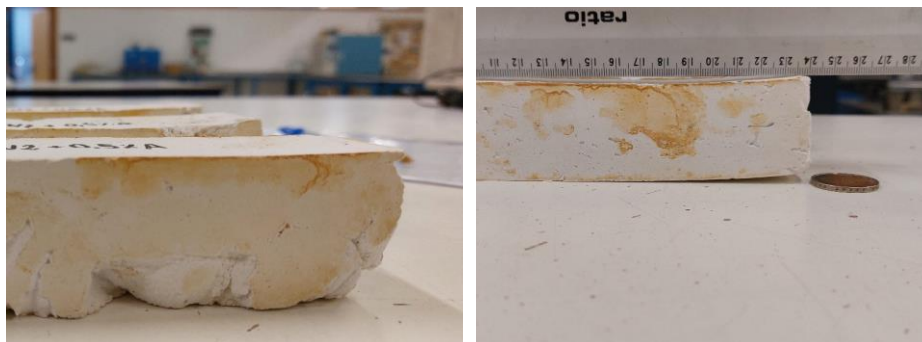
Figura 11.4. Aspecto en estado endurecido de las dosificaciones Y0,5PY2+0,5\%A y Y0,5PY2+1\%A
