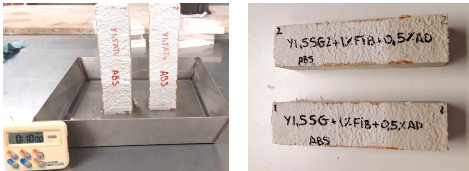
Figura 5.25. Ensayo de absorción de agua por capilaridad según la norma RILEM TC 25-PEM
