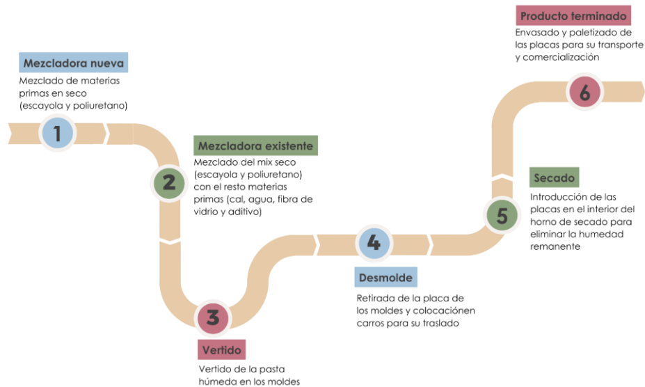
Figura 8.10. Esquema de fabricación de la placa de escayola con residuo de poliuretano para techos suspendidos desmontables
