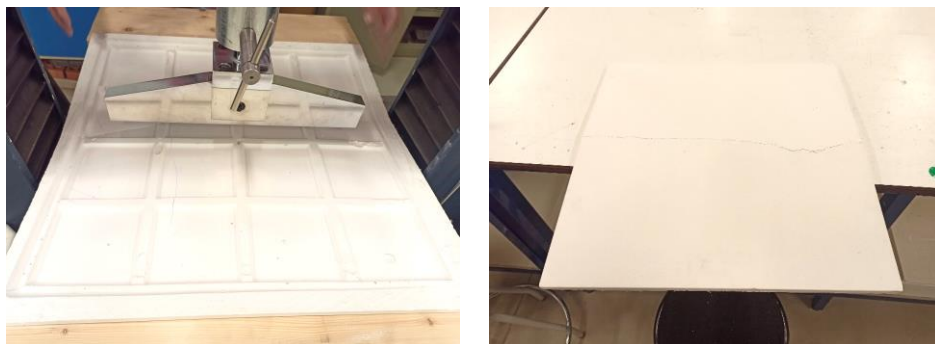
Figura 8.24. Inspección visual de la placa de yeso estándar (izquierda) y de la placa yeso-PU (derecha) tras el ensayo de resistencia a flexión
