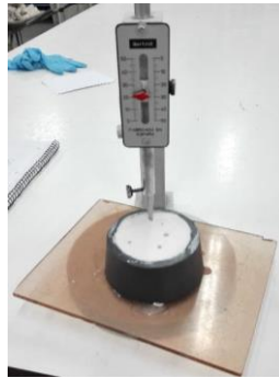
Figura 5.21. Procedimiento de ensayo de principio de fraguado
