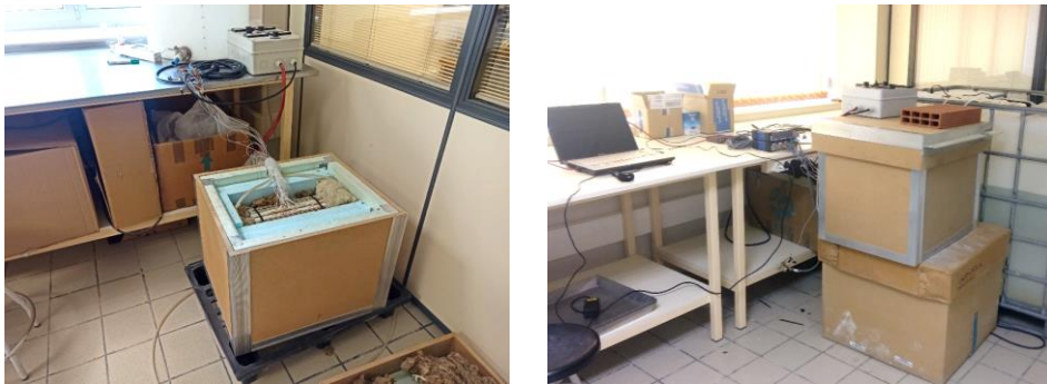
Figura 5.8. Equipo y procedimiento de ensayo de placa caliente guardada (UBU)
