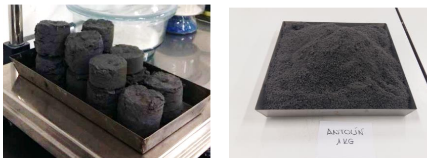
Figura 6.5. Residuo de poliuretano tipo A según el formato suministrado (izquierda) y tras el proceso de trituración (derecha)
