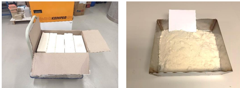
Figura 6.3. Residuo de poliuretano tipo B según el formato suministrado (izquierda) y tras el proceso de trituración (derecha)
