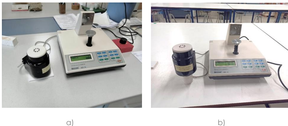
Figura 5.10. Equipo y procedimiento de ensayo de colorimetría
