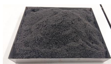
Triturado y tamizado (pasa del tamiz de 2,00 mm)
