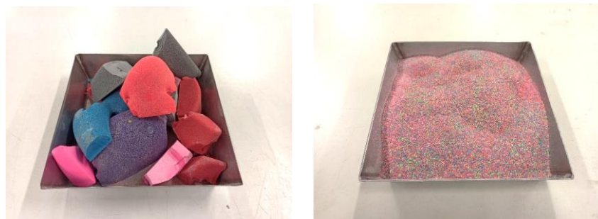
Figura 6.9. Residuo de poliuretano tipo ES según el formato suministrado (izquierda) y tras el proceso de trituración (derecha)
