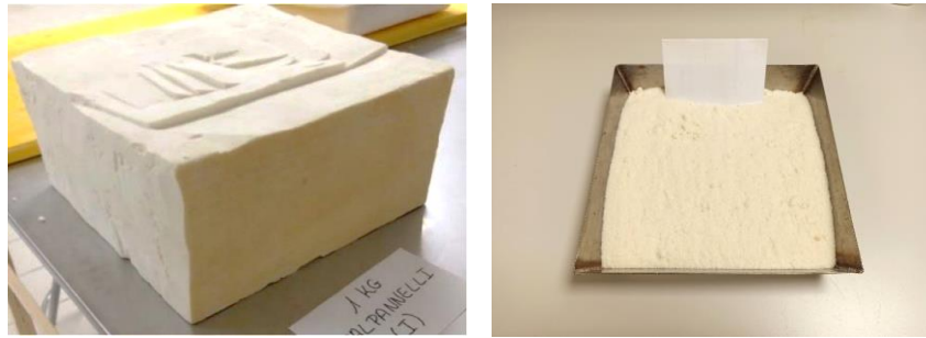
Figura 6.2. Residuo de poliuretano tipo I según el formato suministrado (izquierda) y tras el proceso de trituración (derecha)
