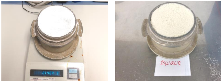
Figura 5.3. Procedimiento para determinar la densidad aparente de productos en polvo
