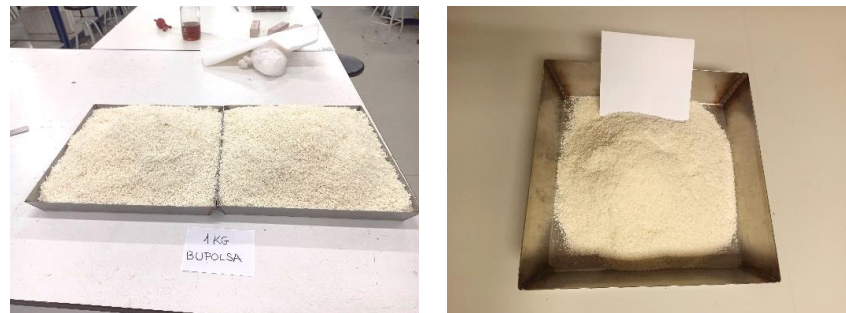
Figura 6.8. Residuo de poliuretano tipo BU según el formato suministrado (izquierda) y tras el proceso de trituración (derecha)
