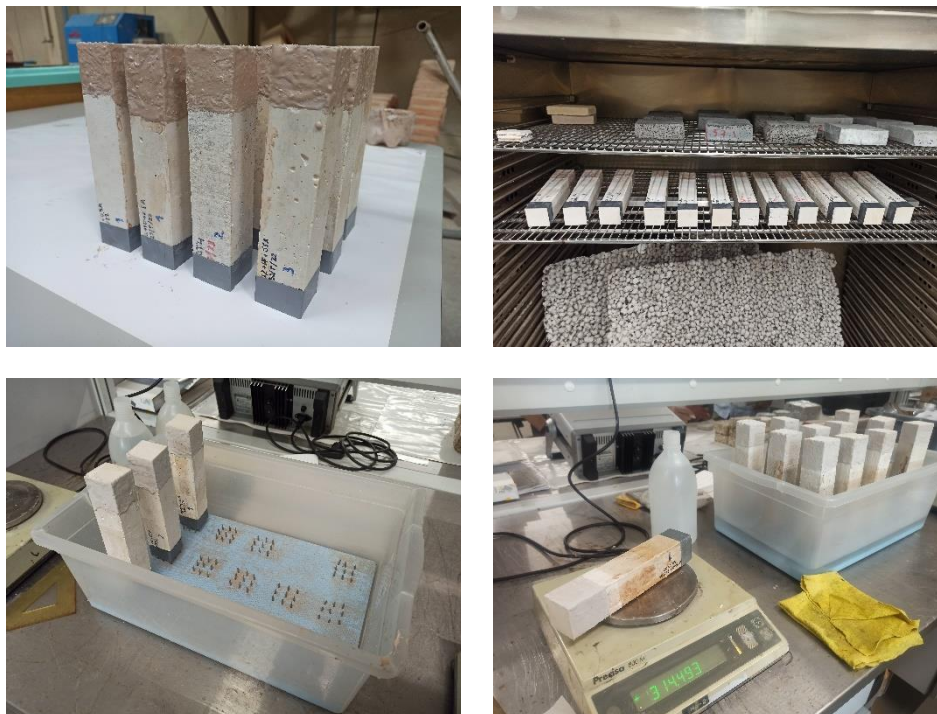
Figura 5.26. Preparación de las muestras y ejecución del ensayo para determinar la absorción de agua por capilaridad según la norma UNE-EN 1015-18
