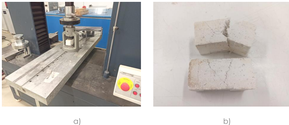
Figura 5.15. Equipo y procedimiento de ensayo para determinar la resistencia a compresión
