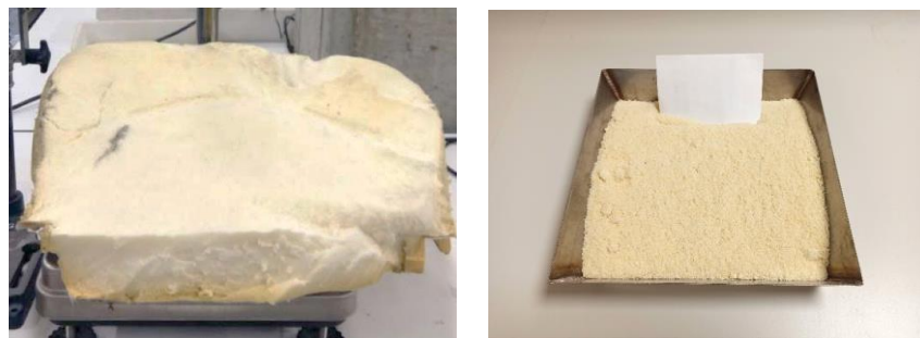
Figura 6.7. Residuo de poliuretano tipo SG según el formato suministrado (izquierda) y tras el proceso de trituración (derecha)
