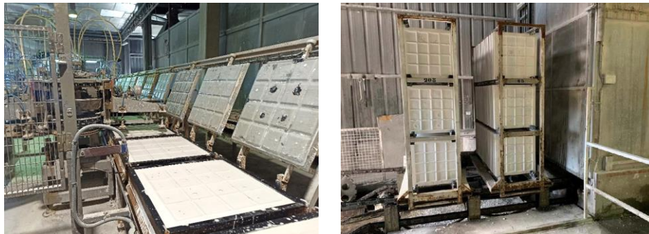
Figura 8.13. Desmoldado de placas y colocación en carros para el secadero
