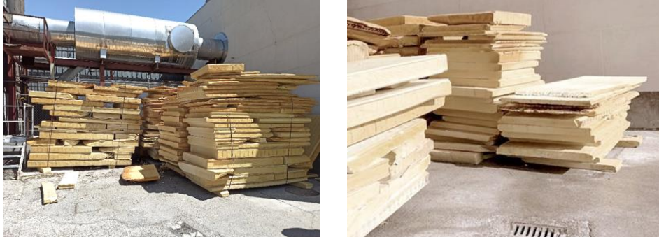
Figura 8.1. Zona de carga-descarga y acopio del residuo de poliuretano
