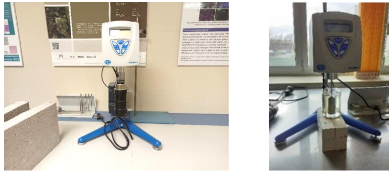
Figura 5.11. Equipo y procedimiento de ensayo de viscosidad aparente
