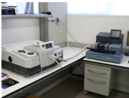
Figura 5.32. Equipo de análisis termogravimétrico Q600 TA Instruments y espectrómetro de infrarrojo FTIR
