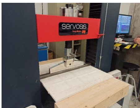
Figura 5.18. Procedimiento de ensayo para determinar la deformación bajo carga
