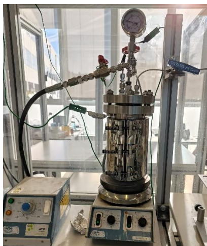
Figura 1. Fotografía del equipo de extracción con agua subcrítica utilizado en este trabajo.
