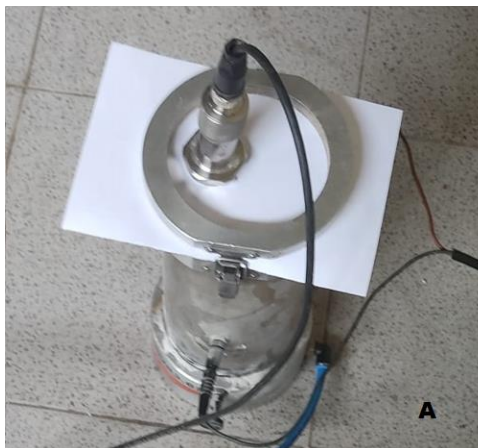
Figura 115. A – Montaje del transmisor de presión en el equipo Hartmann; B – Detalle del transmisor.
