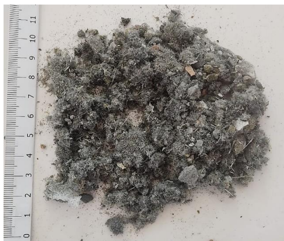
Figura 102. Fotografía del aspecto de la muestra de espuma de poliuretano gris.
