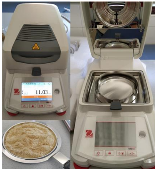
Figura 23. Fotografía del equipo analizador de humedad empleado para medir la humedad de las muestras.
