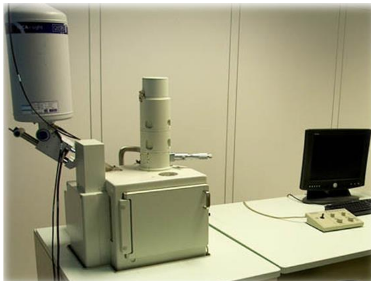
Figura 25. Fotografía del Microscopio Electrónico de Barrido JEOL JSM-6460LV.
