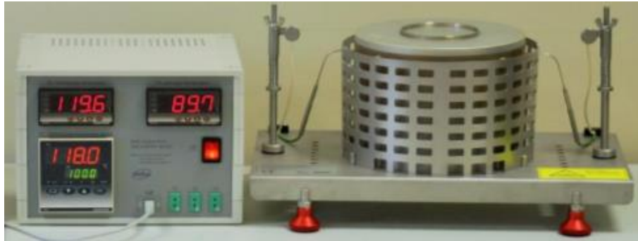
Figura 27. Fotografía del equipo LIT-3 para la determinación de la TMI capa.
