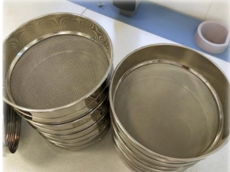
Figura 21. Fotografía de los tamices empleados en la determinación granulométrica.
