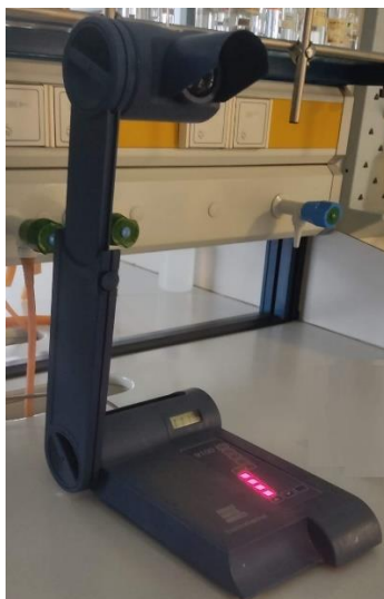
Figura 94. Fotografía del aparato IA-9100 de VWR medidor del punto de fusión.
