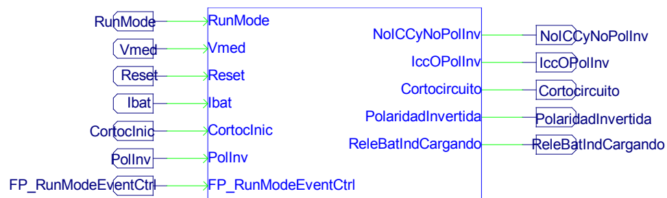
Figura 1-125 Subcircuito que implementa las protecciones
