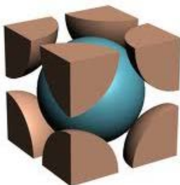
Figura 2.12.: Estructura cúbica centrada en el cuerpo (BCC).
