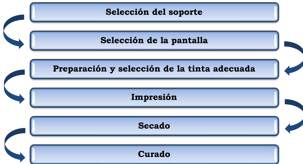
Figura 2.7.: Esquema de las etapas necesarias en la construcción de electrodos serigrafiados.
