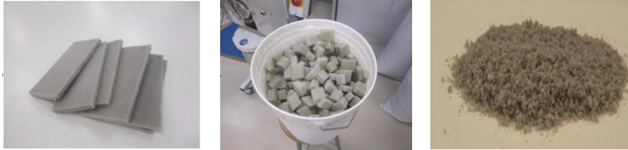
Figura 5.4 Proceso de obtención de la espuma gris triturada
