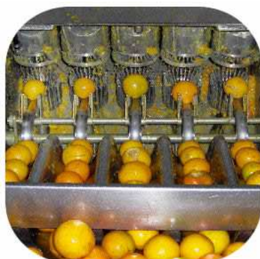
Figura 3.6. Extractor de jugo y aceite esencial para cítricos marca Speciale. (Omnia SRL, 2007)
