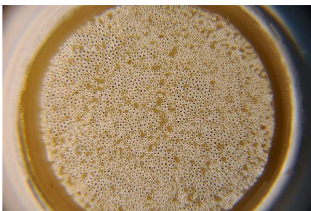
Figura 3.8. Vista en sección de las membranas de ultrafiltración. (Elessia, 2013)
