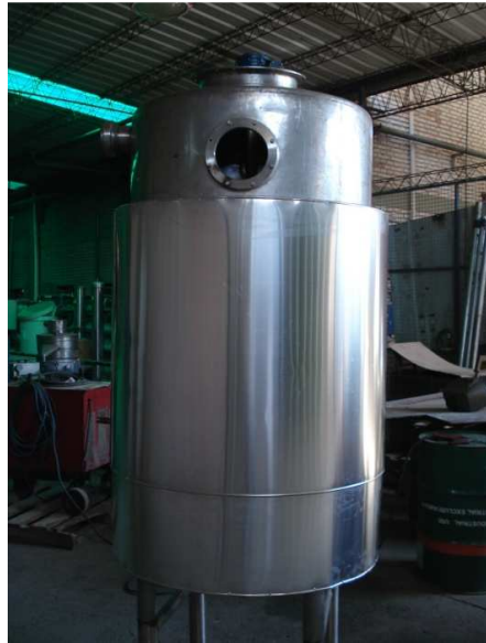
Figura 7.23. Vista externa del biodigestor escala piloto.
