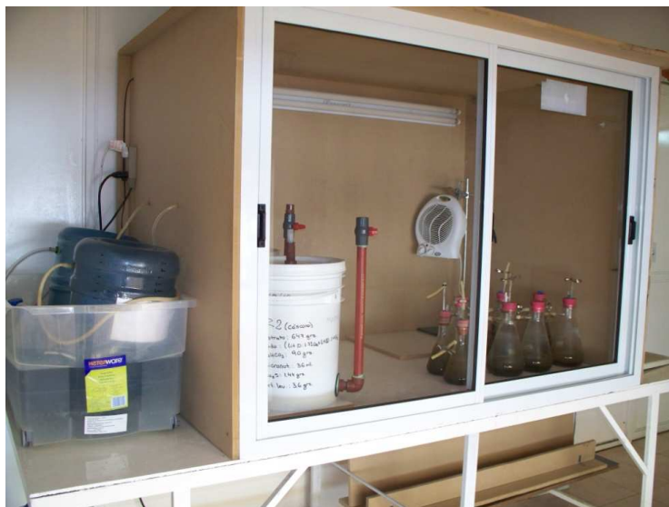
Figura 7.11. Vista exterior del gabinete termostatzado
