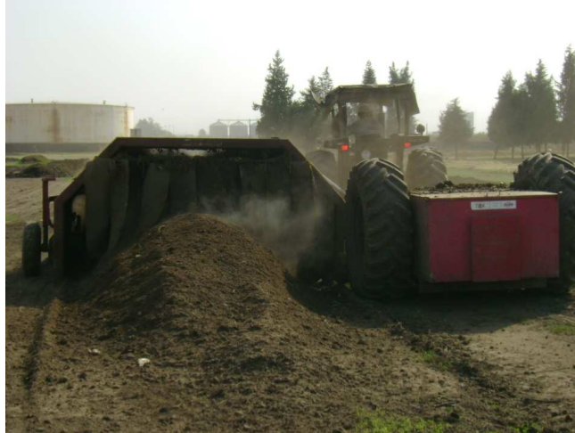
Figura 3.16. Proceso de aireación o volteo de la pila de compostaje.
