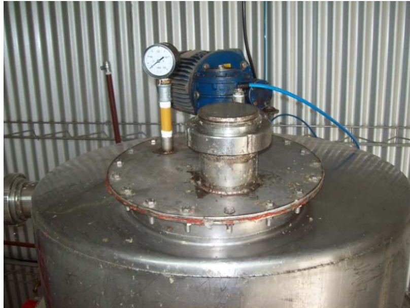
Figura 7.25. Parte superior del biodigestor donde destaca el manómetro, el motor del agitador, la salida de biogás (manguera azul) y la boca de alimentación (cerrada).
