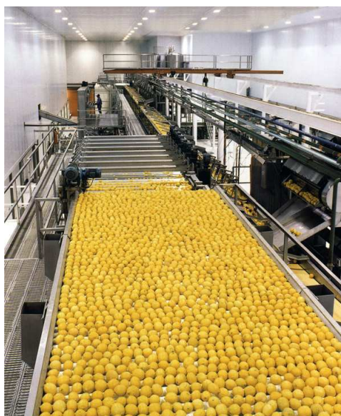
Figura 3.5. Línea de descarte manual y clasificación por tamaño. (Vicente Trapani S.A., 2014)
