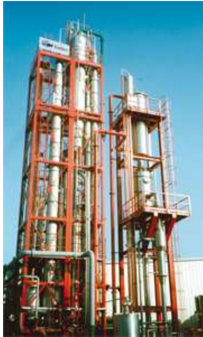
Figura 3.10. Evaporador tipo TASTE. (JBT Corporation - 2009)
