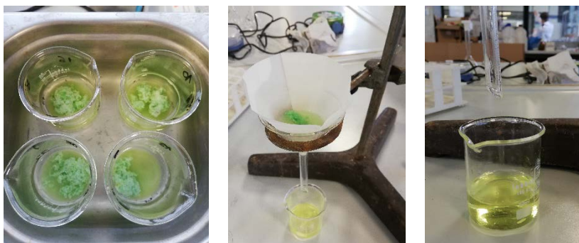
Figura 3. Procedimiento experimental: agitación en ultrasonidos y filtrado para extraer los colorantes de las muestras de cerezas.
