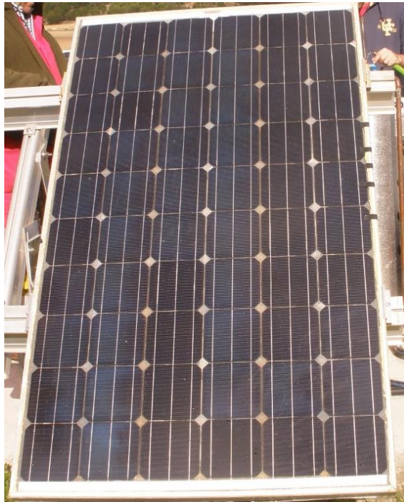
Figura II.18: Segundo prototipo de panel PV/T colocado en la instalación de prueba.
