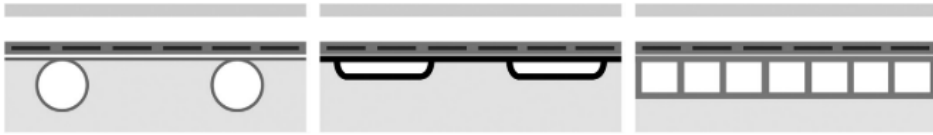
Figura I.17: Diferentes posibilidades en la forma del tubo del colector térmico de un panel PV/T [49] (Sección en forma rectangular es la que mejor rendimiento térmico y eléctrico obtiene)
