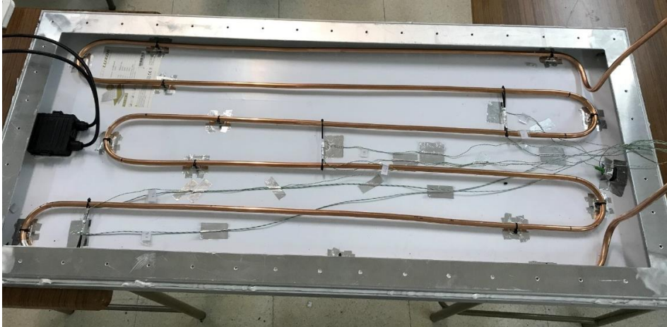
Figura II.20: Prototipo PV/T+PCM con el tubo recuperador de calor y los termopares colocados. Paso previo al vertido del PCM
