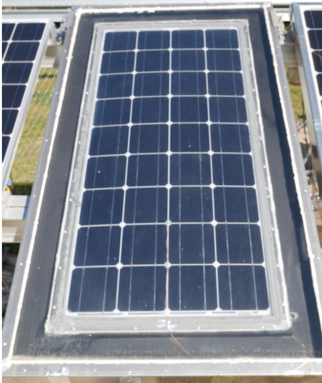
Figura II.29: Prototipo de panel PV/T con acumulación de calor mediante PCM y heat pipes para mejorar el proceso de fusión del PCM
