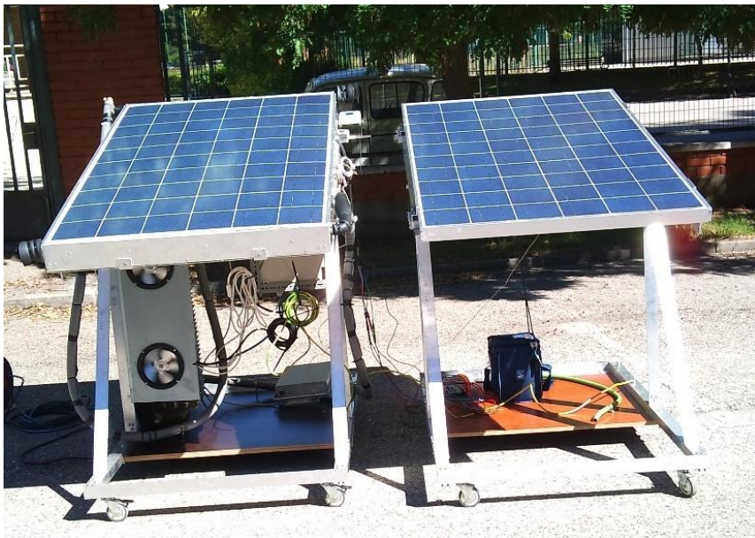
Figura II.7: Estudio comparativo de panel fotovoltaico (derecha) y panel PV/T (izquierda).
