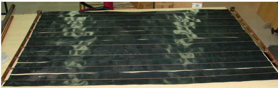
Figura II.8: Colector térmico utilizado para el prototipo de PV/T
