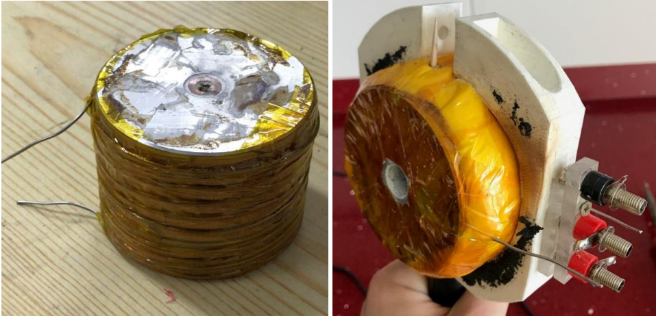
Figura III.10: Evaporador para el heat pipe formado por un bloque de aluminio.
