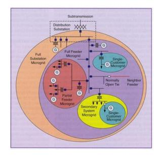
Figura 5. Estructura del Sistema Eléctrico del Futuro. Fuente: IEEE Power & Energy. Vol.14, Number 5, September/October 2016
