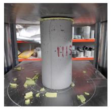
(b) Cylinder:  $\phi 100 \ge 200 \text{ mm}$
