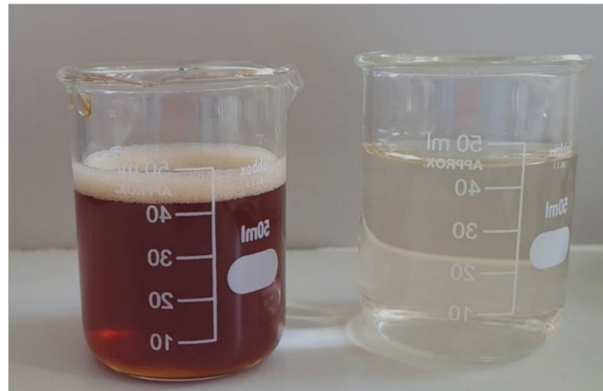
Figura 10. Fotografía del retenido (izquierda) y permeado (derecha) obtenidos después del experimento de concentración mediante nanofiltración utilizando la membrana NF90 (200 Da).
