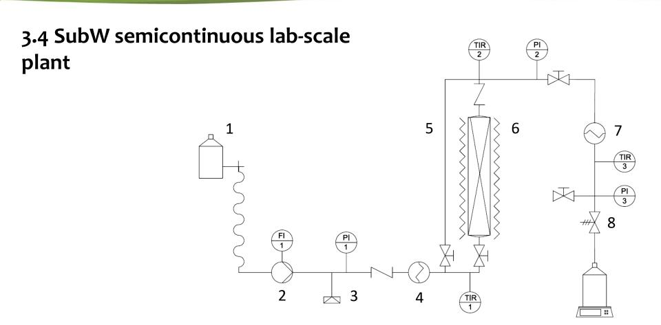
1) solvent bottle; 2) pump; 3) bursting disk; 4) heater; 5) by-pass pipe; 6) 26 mL extractor; 7) chiller; 8) backpressure regulator.
