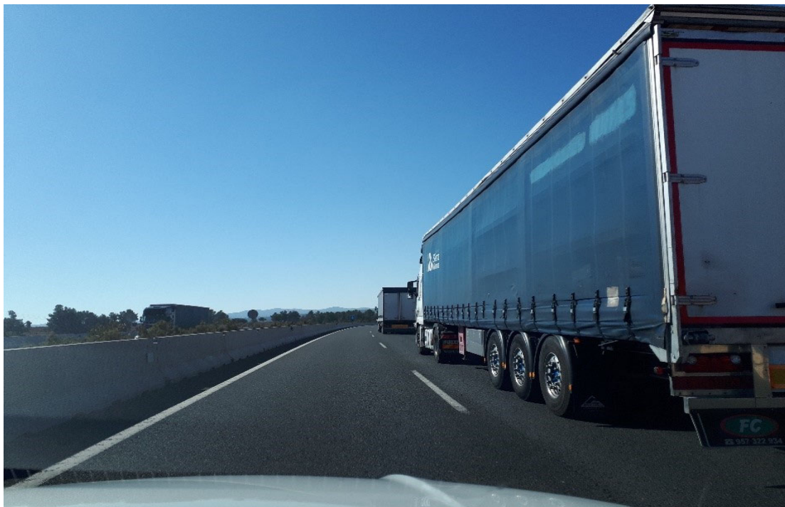
Figura 1: Efecto de apantallamiento en las maniobras de adelantamiento a un grupo de camiones
