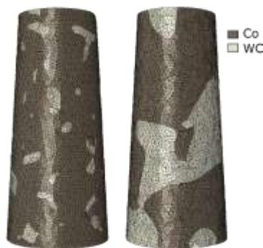
Figura 1: Microestructura de WC-Co reconstruida: tamaño de grano fino y grueso.
