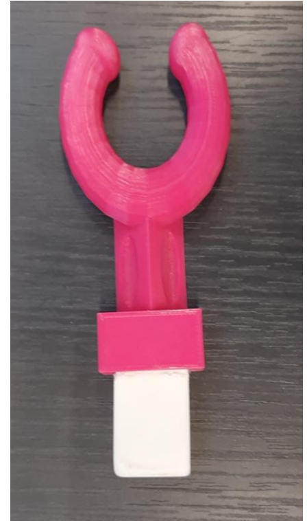
Imagen 9. Producto de apoyo para manejar goma de borrar. Elaborado para niña de 6 años con lesión medular.
