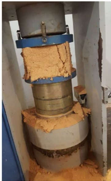
a.- Prueba resistencia a compresión
