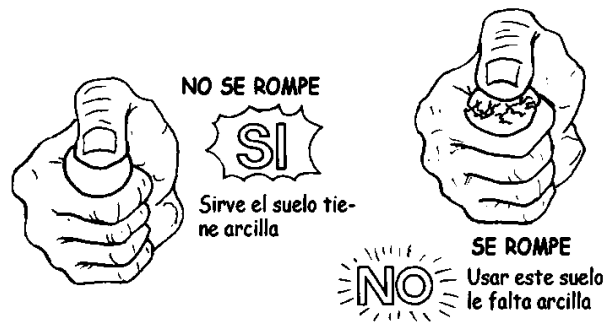
Figura 2.10 Presencia de arcilla, Fuente: “Diseño y construcción con tierra reforzada NORMA E. 080,” 2017 [22]
