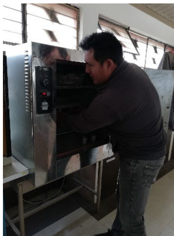
Figura 2.17 Contenido de humedad de los áridos, Fuente: Elaboración Propia
