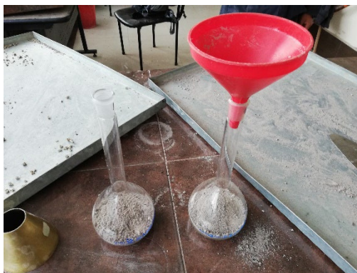
Figura 2.15 Densidad real del árido fino, Fuente: Elaboración Propia
