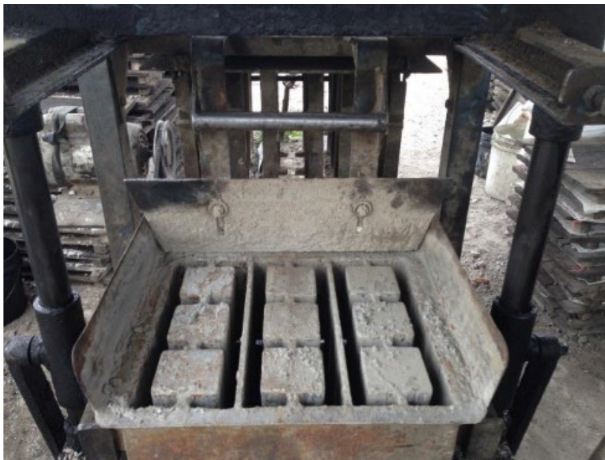
Figura 3.16 Proceso de moldeo de bloques, Fuente: Elaboración Propia
