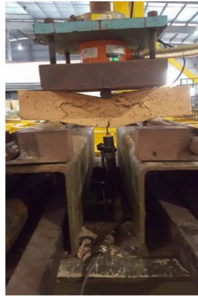
b.-Prueba resistencia a flexión
