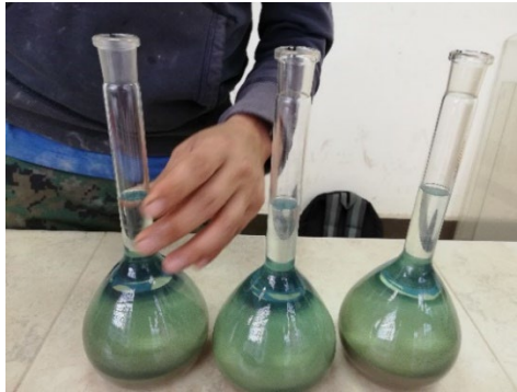
Figura 2.16 Densidad real del cemento, Fuente: Elaboración Propia
