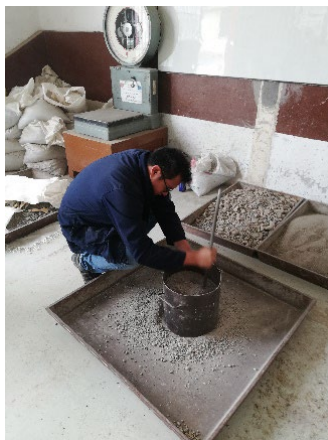
Figura 2.13 Densidad aparente compactada de los áridos, Fuente: Elaboración Propia
