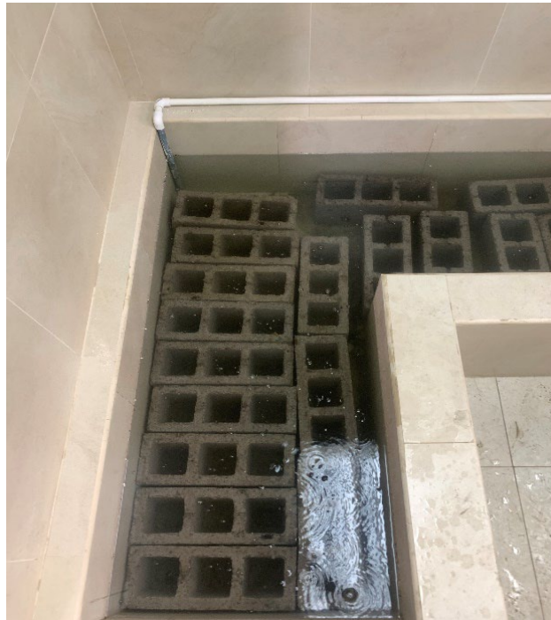
Figura 3.17 Curado de bloques alivianados de hormigón, Fuente: Elaboración Propia
