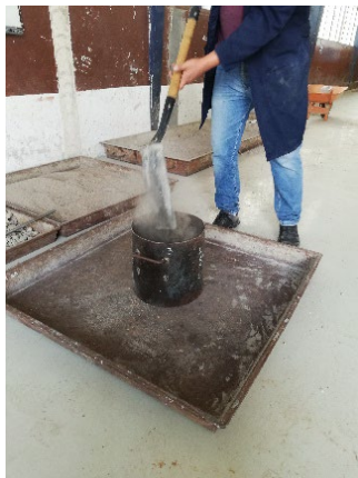
Figura 2.12 Densidad aparente de los áridos. Fuente: Elaboración Propia
