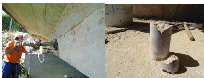
Figura 03: Probeta T1. Extracción de testigo y muestra
