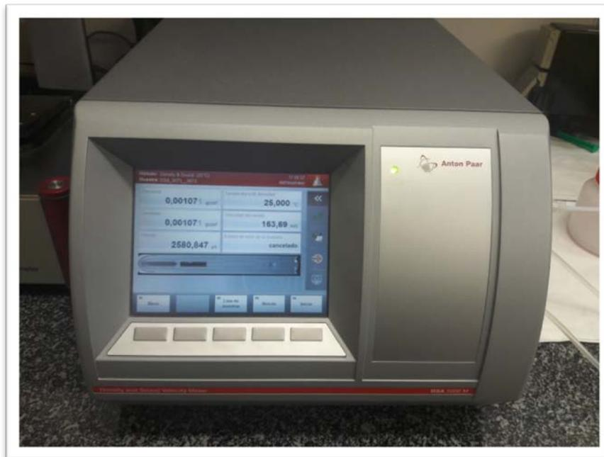
Figure 5. 5 : Le Densimètre DSA 5000 d'Anton Paar USA Inc
