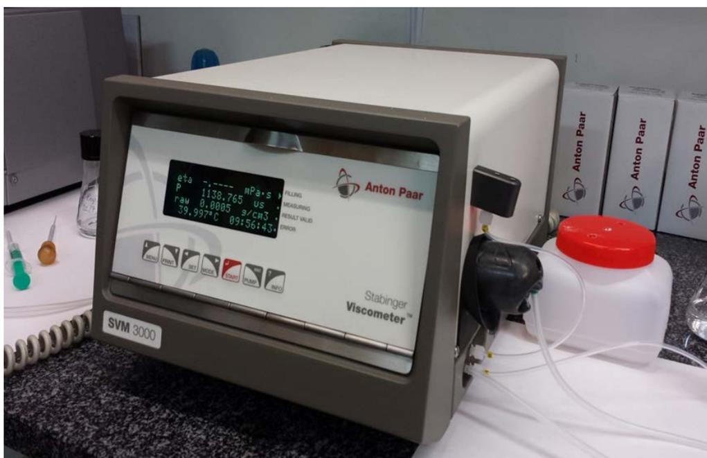
Figure 6. 4 : Vue globale du viscosimètre SVM 3000 dans le laboratoire de génie énergétique de la Universidad de Burgos.
