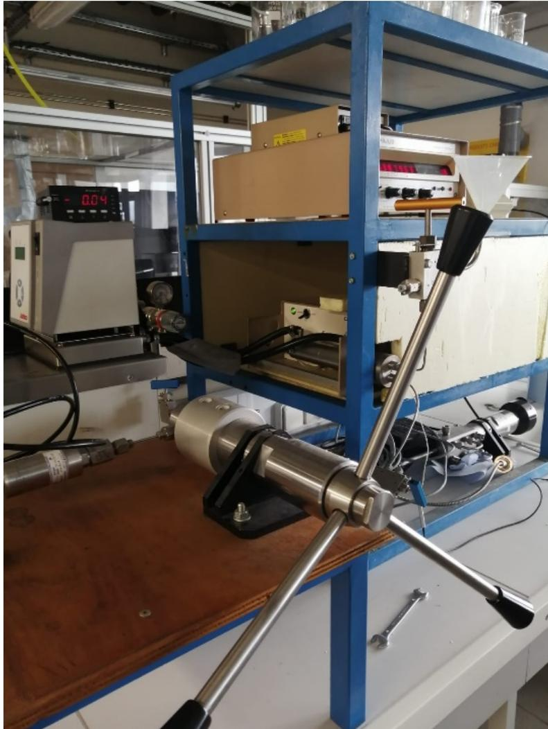
*Figure 5. 3 : Vue générale du système de mesure de la masse volumique à haute pression au Laboratoire des Fluides Complexes et leurs Réservoirs de l'Université de Pau et Pays de l'Adour.*
