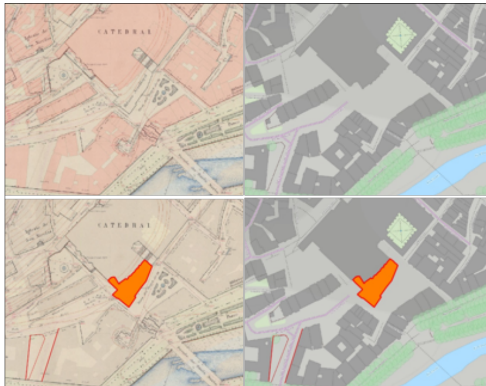
Figura 5: Conversión a vectorial de un edificio antiguo desaparecido. Identificación geométrica, medición de superficies e integración en la cartografía actual
