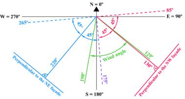
Fig. 4. Wind load angles on the façades.
