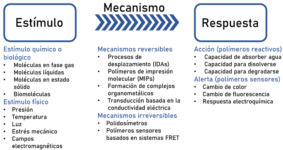
Figura 3. Clasificación de los polímeros inteligentes en función del estímulo, el mecanismo que tiene lugar y la respuesta generada.
