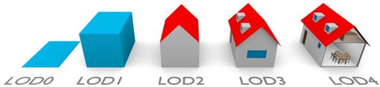
Figura 10. Clasificación de CityGML de niveles de detalle en modelado de entornos urbanos.
